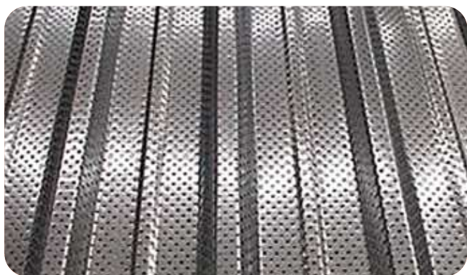
Telha LR 40 com perfuração total (13,64%), diâmetro do furo de 4,75 mm, distância entre centros de 12,2 mm, diagonal.
